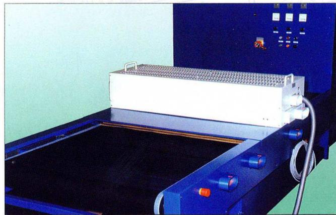
UV-Bandrockner 1200 mm Arbeitsbreite und 30 kW Leistung
