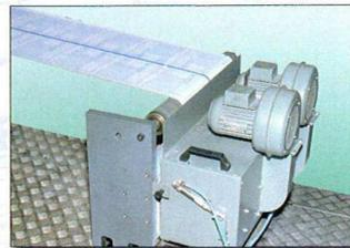
UV-Anlage 520 mm, 10 kW für Rollenoffset.
